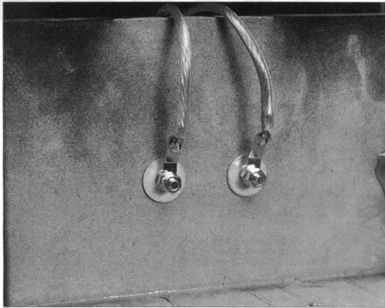
Vorbildlich: Die High-End-Anschlüsse des ESL 55 akzeptieren Kabelschuhe und Bananenstecker
