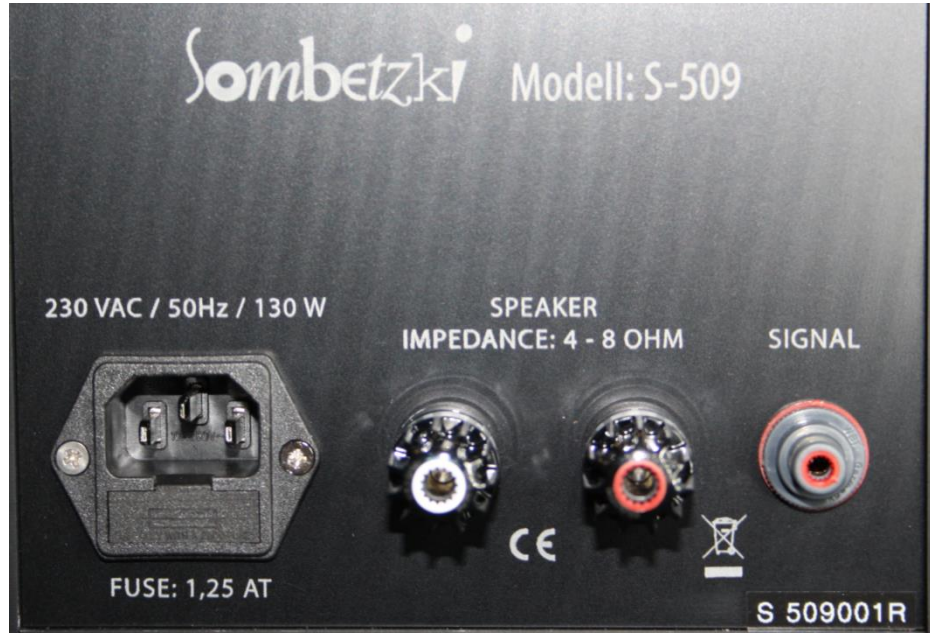
Anschlußseite Verstärker rechter Kanal | Seriennummer unterhalb Cinchbuchse
